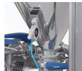
9A802-020: vibrador neumático. Incluye botón en el cuadro eléctrico para parar/ arrancar el vibrador.
