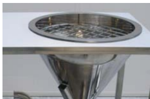
9A808-026BTE: rete di sicurezza all'interno della tramoggia.
