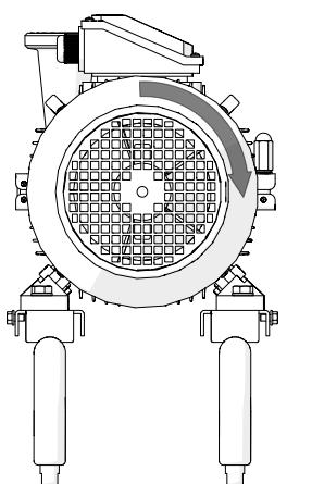
mettez en marche le moteur et arrêtez-le momentanément. Assurez-vous, en regardant la pompe depuis l'arrière, que le ventilateur du moteur tourne dans le sens des aiguilles d'une montre.
