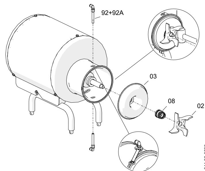
5. Démontez la roue (02). Si nécessaire, donner un coup sec avec un maillet en plastique pour dégager le cône.
