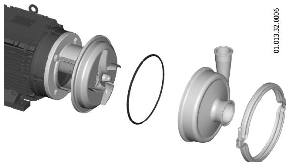
3. Desmonte los tornillos (50A) y los protectores de la linterna (47A).
